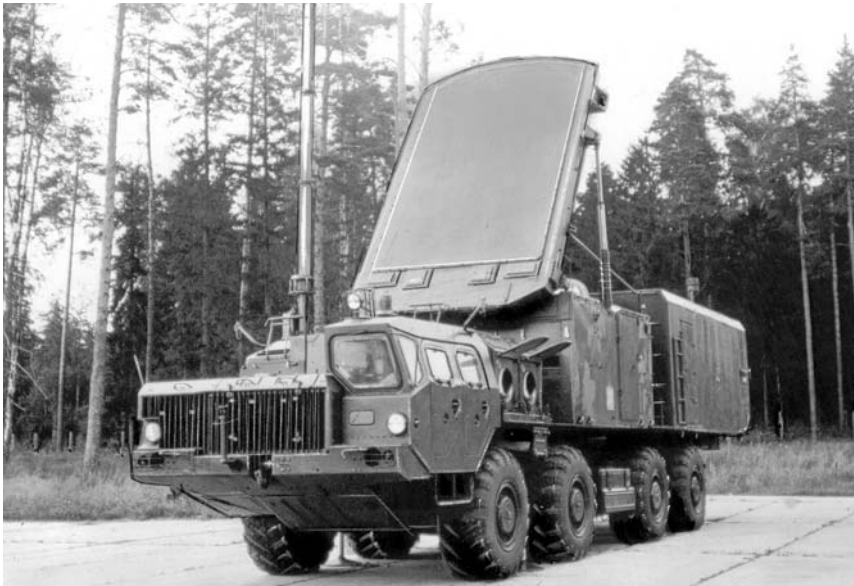
С-300П. Многоканальный радиолокатор наведения ракет.
