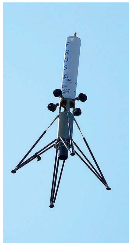
Простейший экспериментальный аппарат для тестирования алгоритмов посадки многоразовых ракет-носителей FROG (CNES)
