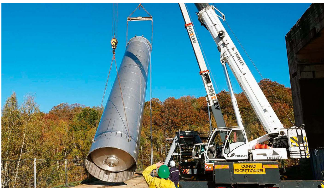
Бак первого опытного образца ракеты-демонстратора Themis
