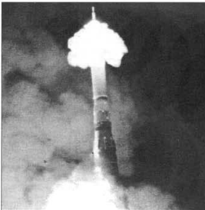
Авария второй «Н-1». Срабатывает система аварийного спасения
