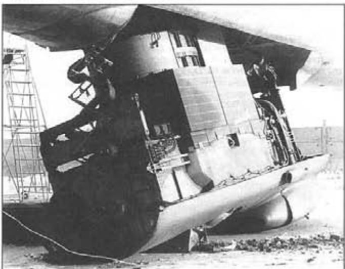
Ту-95ЛАЛ. Демонтаж реактора. На бетоне — осколки защитного слоя
