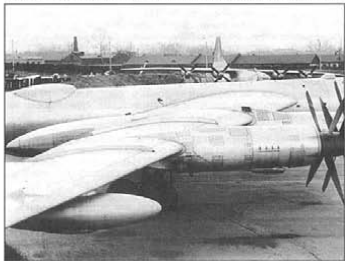
Ту-95ЛАЛ. На переднем плане — контейнер с датчиком излучения Ту-95ЛАЛ. In the foreground - container with radiation sensor
