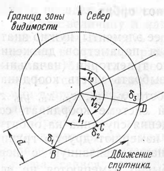
Рис. 1.31. Азимут и угол места в начале и конце сеанса связи.
