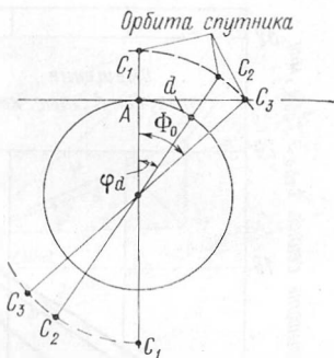
Рис. 1.27. Расчет продолжительности сеанса связи при смещении трассы
