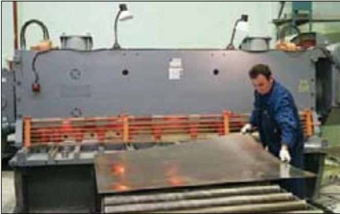
новые гидравлические гильотинные ножницы. Станок, представляющий собой стол с закреплённым над ним комплектом ножей, послужит для самых разнообразных производственных нужд, связанных с резкой металла. В частности, с его помощью будут производиться так называемые подкладные
