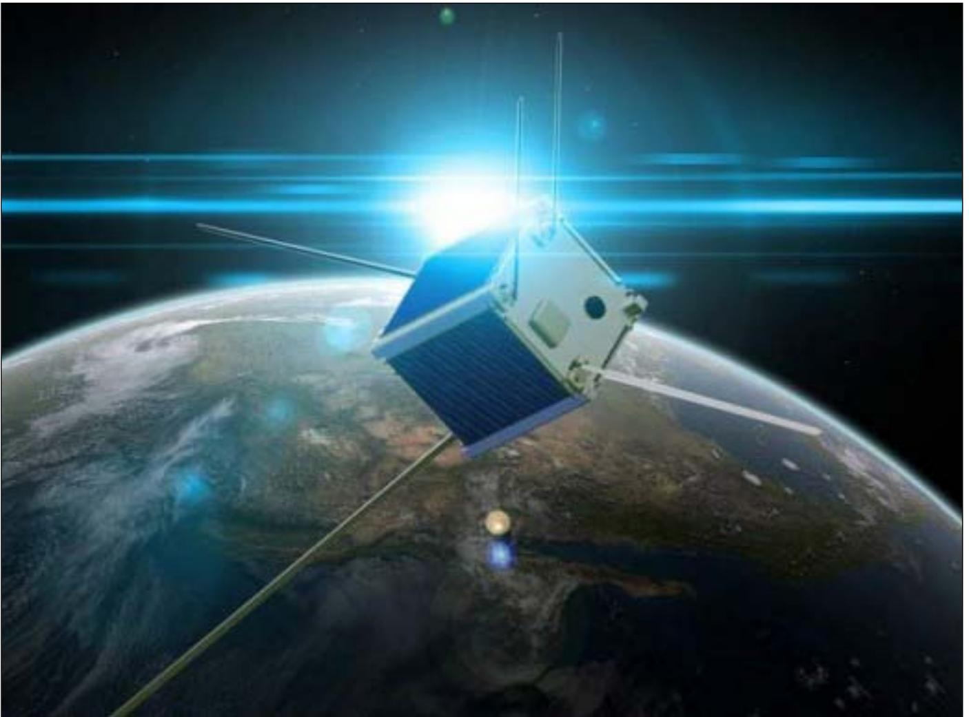
Примечательно, что сей аппарат будет использоваться для очистки околоземной орбиты от многочисленных обломков спутников и прочих фрагментов космического мусора. Миниатюрный спутник, весом всего 1 килограмм, будет действовать на орбите в 400 километров и «ловить» там фрагменты космического мусора. Прикрепившись к такому фрагменту, аппарат включит двигатели, и замедлит движение, тем самым сведя с орбиты опасный космический мусор и заставив его войти в плотные слои атмосферы. После этого
