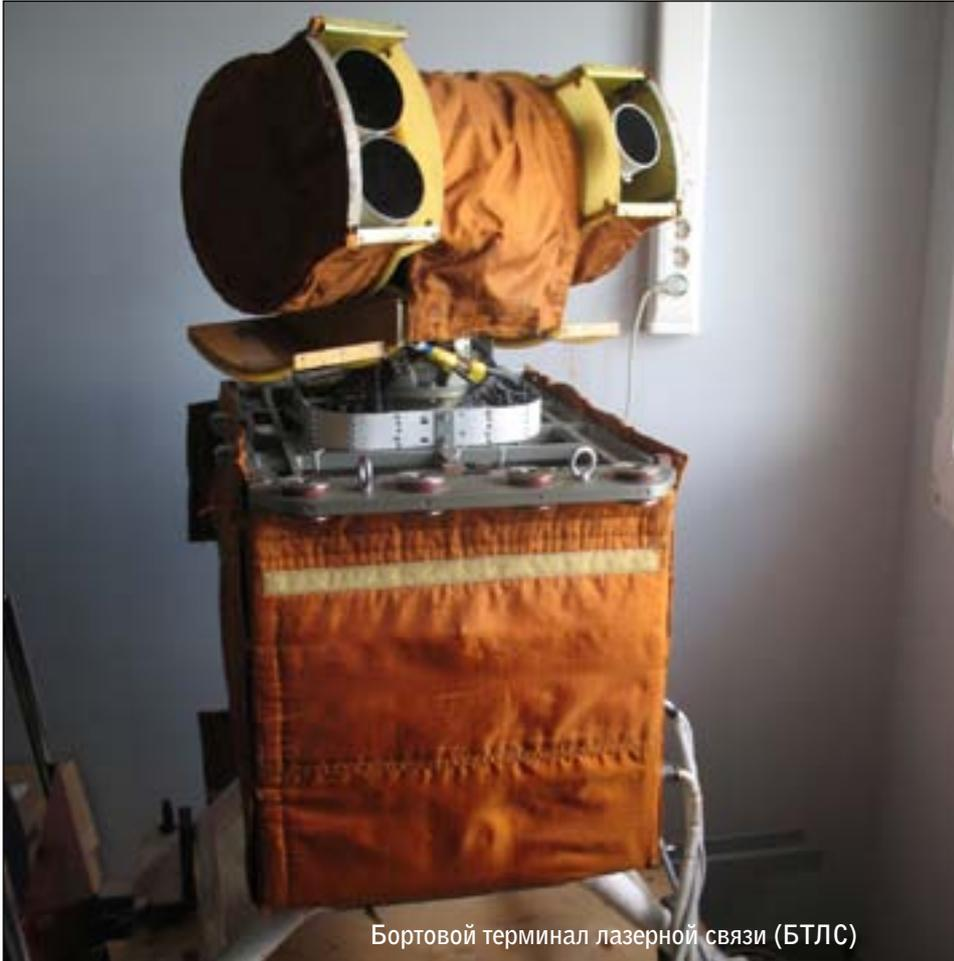
Бортовой терминал лазерной связи (БТЛС)
