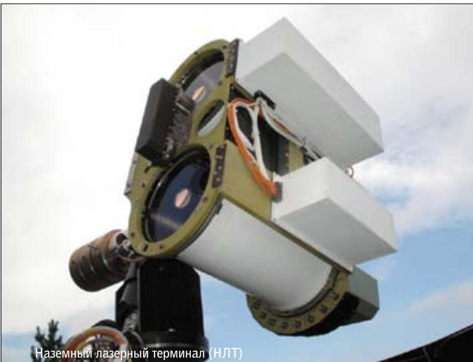
Наземный лазерный терминал (НЛТ)
