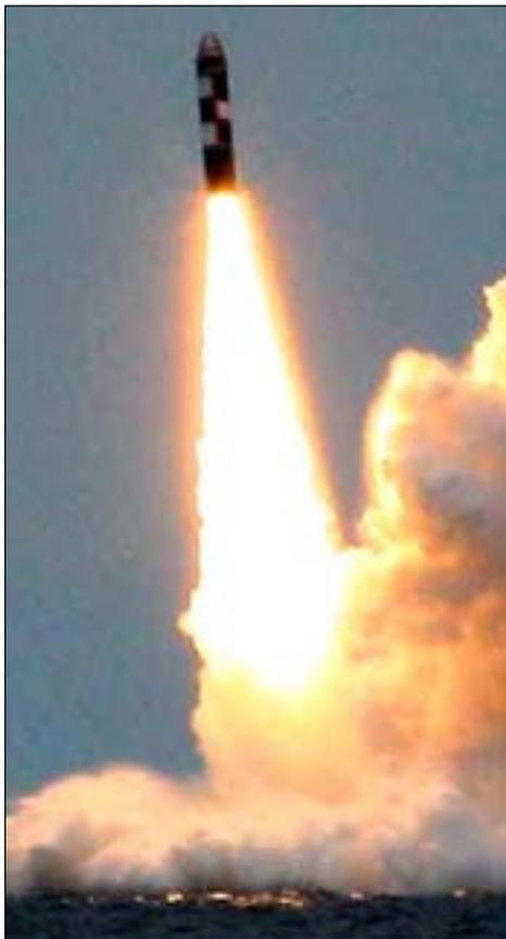
более компактной, чем «Синева». Кроме того, по оценке разработчика, ракета обладает более низким профилем полета и способна неожиданно и резко менять траекторию полета (рыскать) для преодоления противоракетного щита противника. Носитель ядерного оружия также устойчив к факторам ядерного взрыва и воздействию лазерного оружия.
