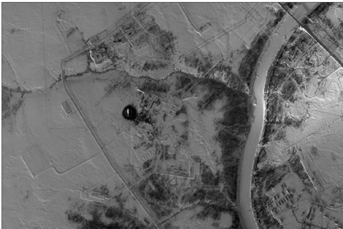
Харьягинское нефтяное месторождение. Снимок EROS B, дата съемки 20 февраля 2013 г. Пространственное разрешение 0,7 м. На снимке видны площадка и горящий факел сжигания попутного нефтяного газа. © ImageSat, ИТЦ «СКАНЭКС»
