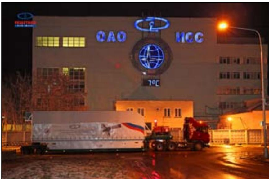
Доставка спутника «Экспресс-АМ5» на космодром запуска прошла в штатном режиме. Транспортировка крупногабаритного космического аппарата проводилась в специальном контейнере, оснащённом системами контроля чистоты, температуры и влажности.
