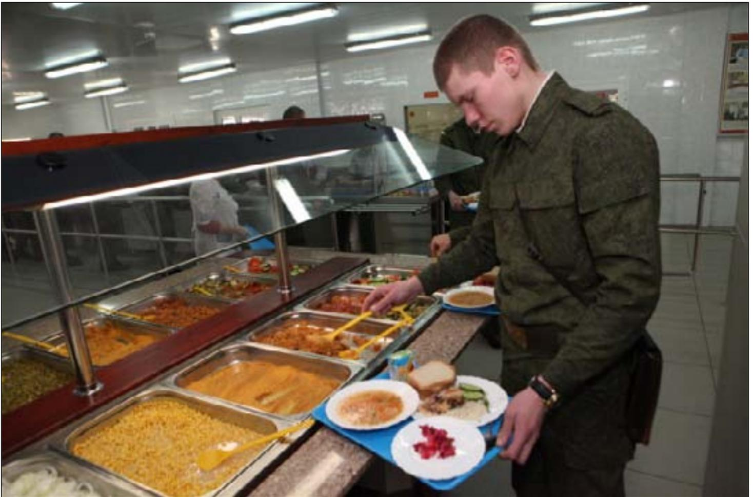
Новое оборудование успешно прошло апробацию и запущено в действие. Линии раздачи, которые рассчитаны на воинские коллективы численностью 150 человек и более, оснащены мармитами — открытыми тепловыми и суповыми столами, предназначенными для поддержания температурного режима пищи.
