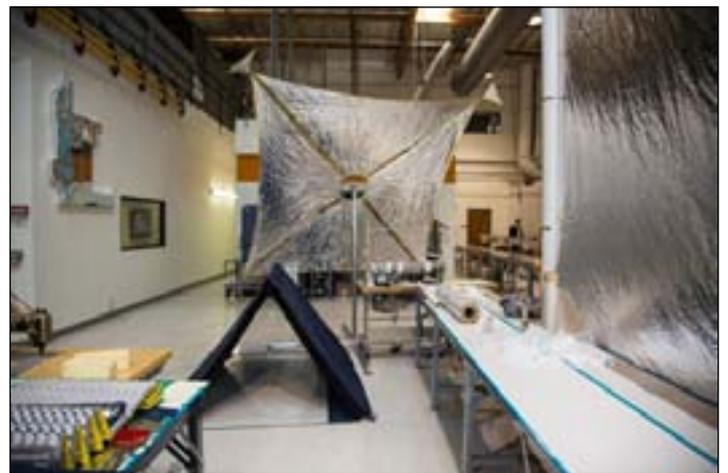
НАСА, корпорация L'Garde и компания Space Services провели наземные испытания части Sunjammer — солнечного паруса, задача которого — демонстрация возможности эффективного перемещения в космическом пространстве исключительно за счёт ускорения, получаемого от Солнца.
