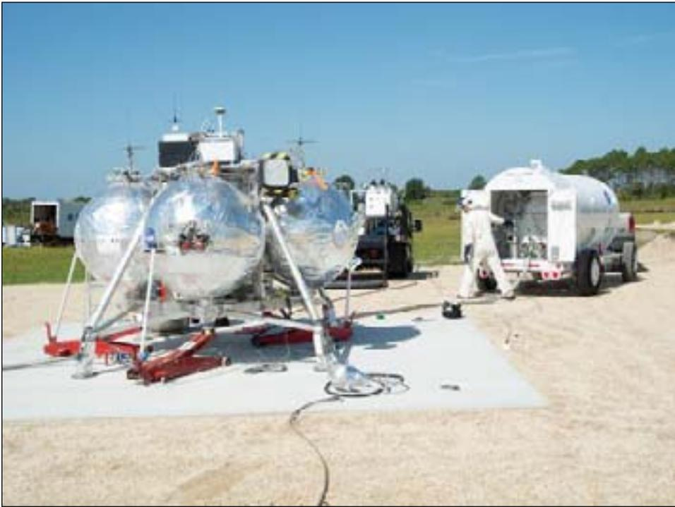
Прототип аппарата многоразового использования для вертикального взлета и посадки, созданного в рамках программы NASA Project Morpheus - совершил еще
