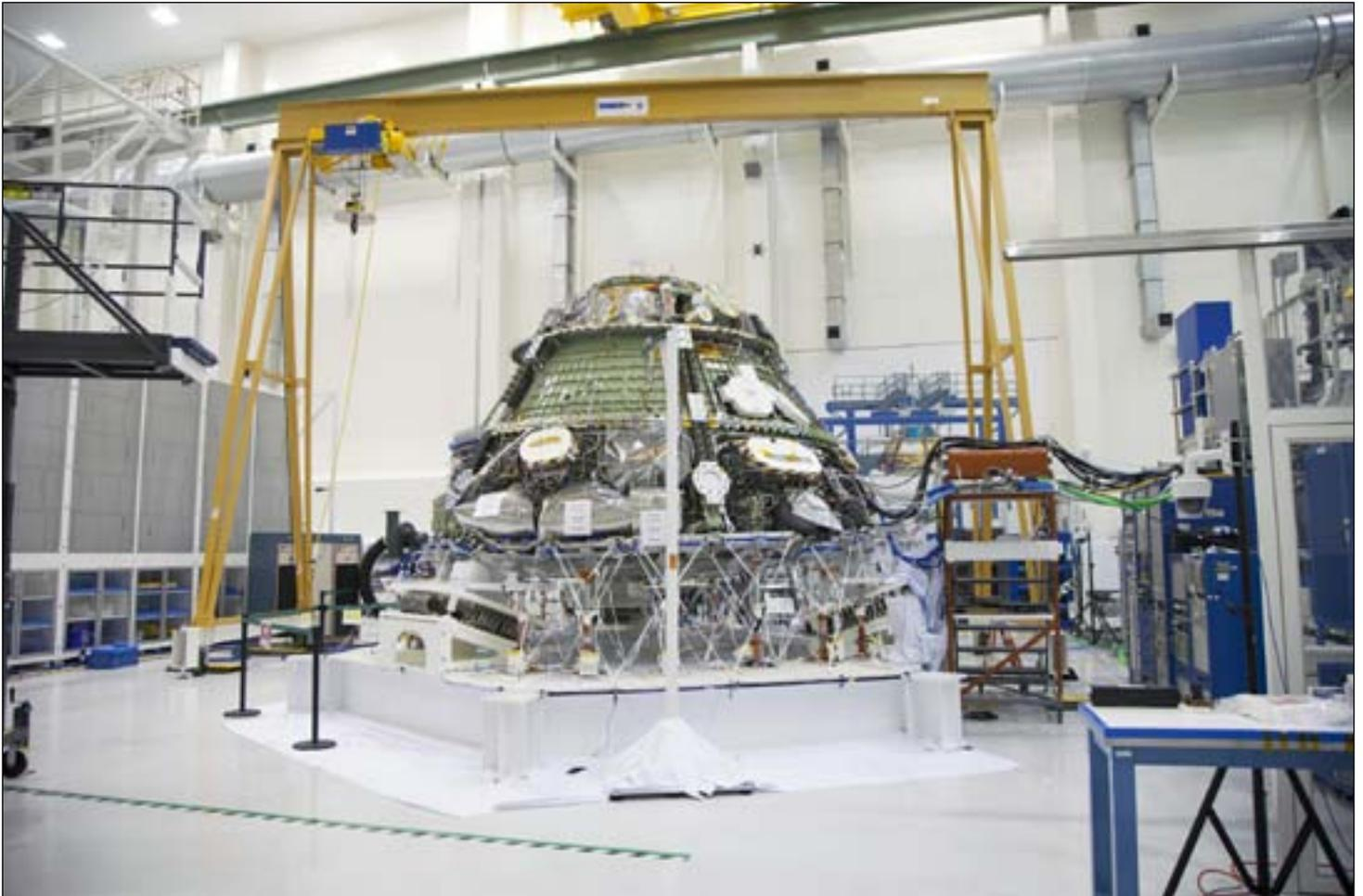
Инженеры компании Lockheed Martin и NASA приступили к процессу установки самого громадного теплозащитного кожуха из когда-либо созданных на модуль отсека экипажа космического аппарата Orion (Орион). Установка теплозащиты – это одна из последних стадий сборки аппарата перед первым испытательным полетом - Exploration Flight Test-1 (EFT-1), который должен состояться в этом году.
