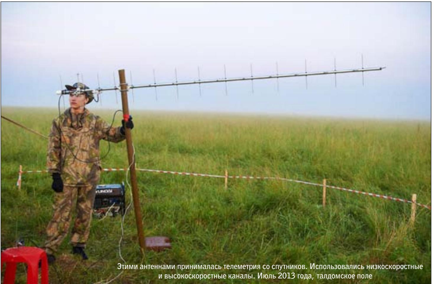
Этими антеннами принималась телеметрия со спутников. Использовались низкоскоростные и высокоскоростные каналы. Июль 2013 года, талдомское поле
