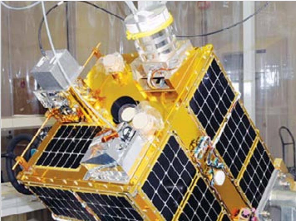
Мини-спутники Omni Earth создаются на основе экспериментальных спутников FASTSat (на снимке), которые были запущены в 2010 году
