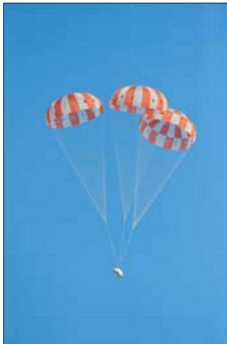
Покрывало переднего отсека – это защитный кожух, который остается на космическом аппарате до тех пор, пока он не совершит повторный вход в атмосферу Земли. Парашюты, которые замедляют движение Orion до скорости, необходимой для того, чтобы совершить безопасное приземление, расположены под кожухом, поэтому кожух должен быть сброшен до того, как распухнут парашюты.
