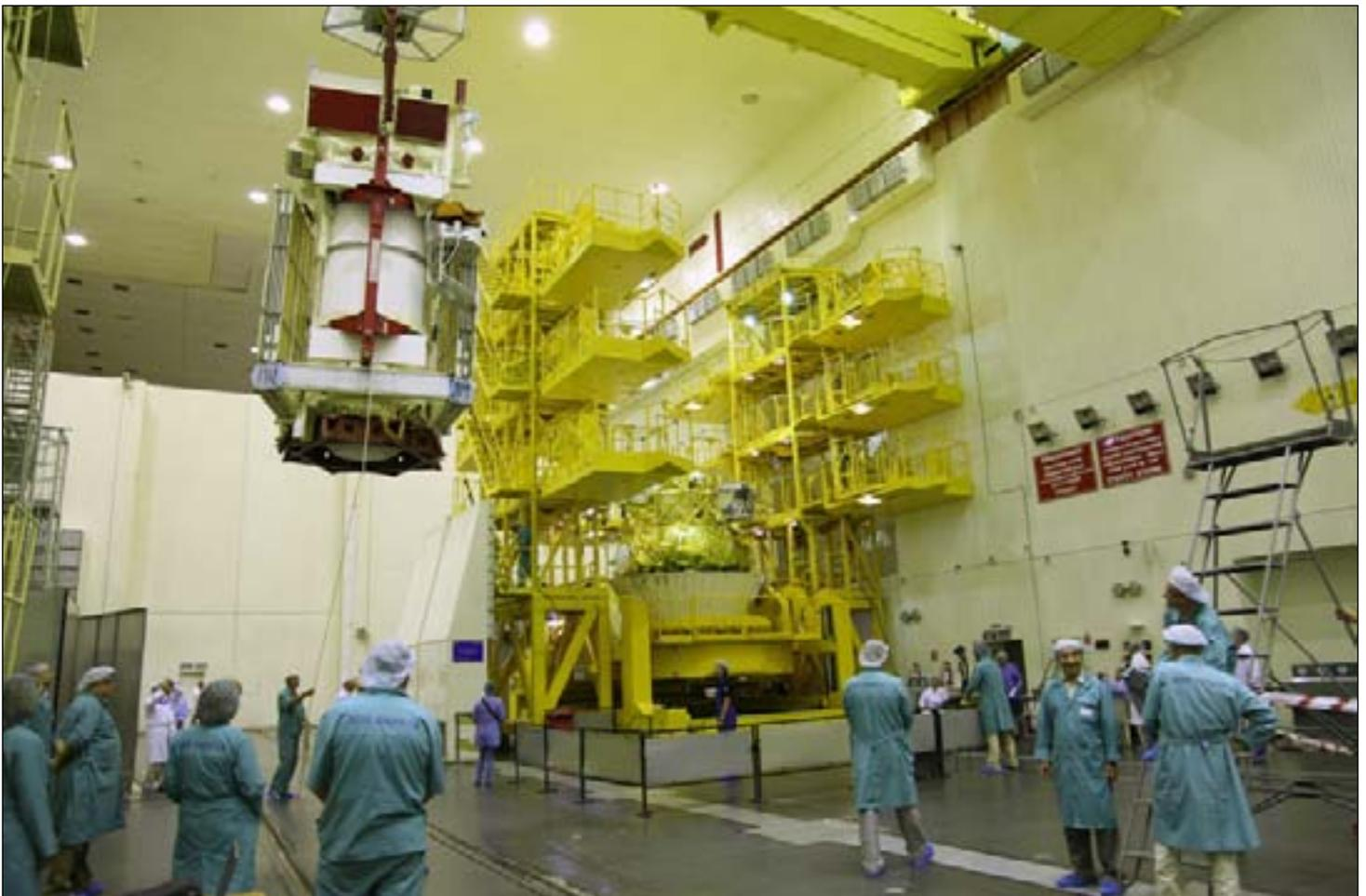
На Байконуре завершаются работы по сборке космической головной части для предстоящего пуска РН «Союз-2.1б» с КА «Метеор-М» и шестью малыми космическими аппаратами.
