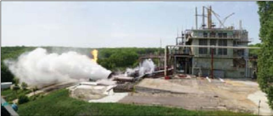
носителей. Огневая отработка этого двигателя успешно проведена в мае-июне 2014 г. на стендовой базе КБХА.
