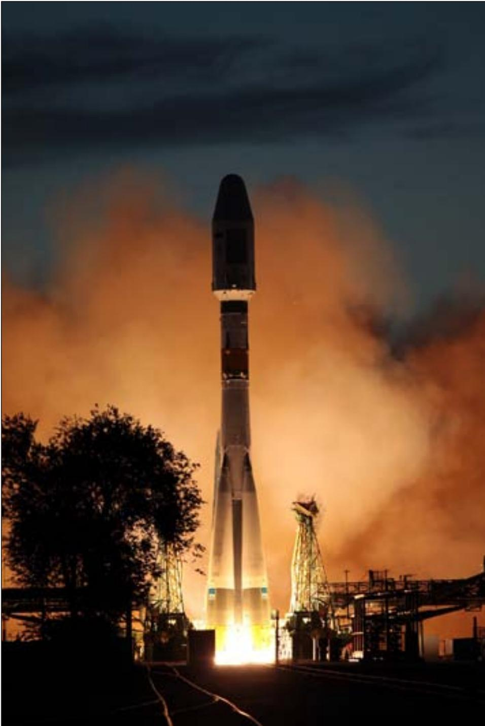
8 июля в 19 час 58 минут московского времени со стартового комплекса пл. 31 космодрома Байконур состоялся пуск ракеты-носителя (РН) «Союз-2.16» с разгонным блоком (РБ) «Фрегат», космическим аппаратом (КА) «Метеор-М» № 2 и шестью малыми космическими аппаратами «МКА-ФКИ», «SkySat-2», «DX-1», «TechDemoSat-1», «UKube-1», «AISSAT-2».
