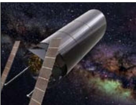
В данный момент ATLAST рассматривается в качестве возможного флагманского проекта НАСА на период в 2025-2035 годы. Данный телескоп должен иметь 15-метровое зеркало, и станет самым большим подобным объектом, когда-либо выводимым в космос. Работать ATLAST будет в видимом, ультрафиолетовом, а также ближнем инфракрасном диапазоне, а срок его службы должен составить не менее 20 лет.
