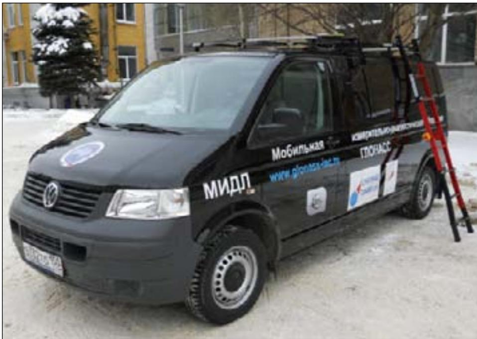
оборудованный специальной контрольной аппаратурой. В комплект оборудования входит мобильный ГЛОНАСС/GPS-приёмник геодезического класса точности, антенна мобильного контрольного приёмника, гироскоп и одометр для измерения параметров движения, аналого-цифровой преобразователь и анализатор сигналов. В зависимости от конкретных задач могут быть установлены дополнительные системы.
