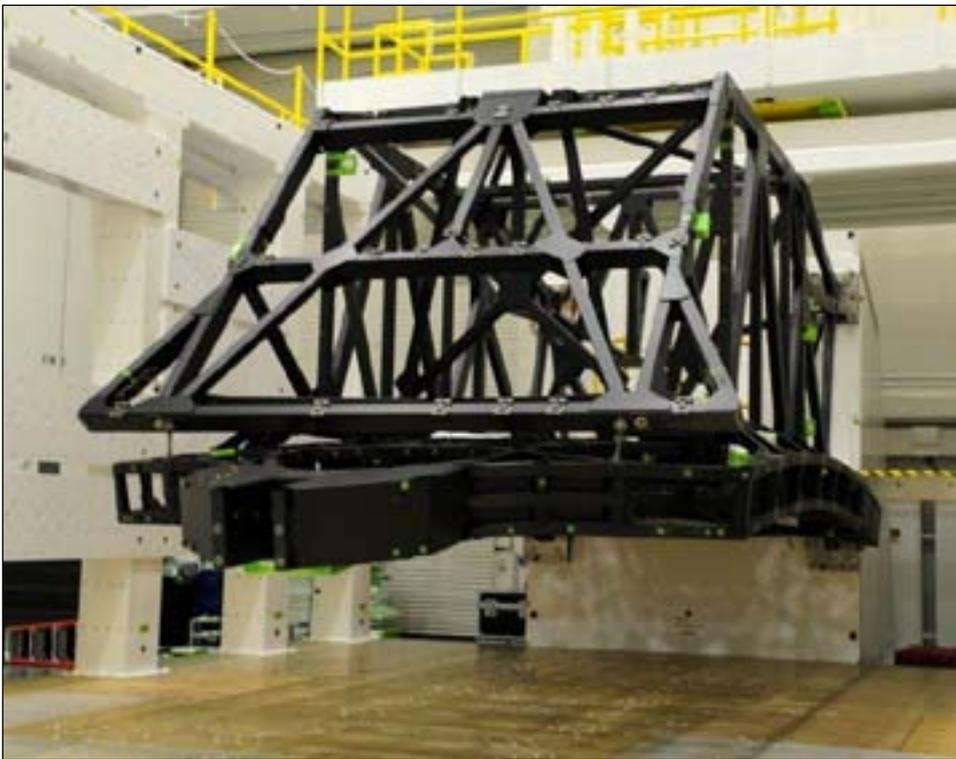
Космический телескоп Джеймса Вебба (James Webb Space Telescope) прошел еще один важный рубеж: завершились испытания поддерживающей структуры панели основного зеркала (PMBS) с постоянной нагрузкой. Таким образом, телескоп на шаг приблизился к запуску, который назначен на 2018 год.
