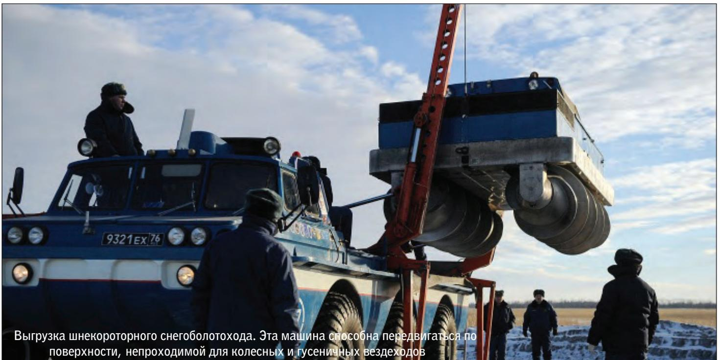
Выгрузка шнекороторного снегоболотохода. Эта машина способна передвигаться по поверхности, непроходимой для колесных и гусеничных вездеходов
