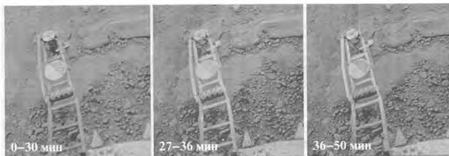
Рис. 4. Конус и измерительная часть пенетратора ВЕНЕРЫ-13 покрылись черным слоем после того, как конус пробил трещину в каменной плите поверхности (левая панель). На ТВ-снимках, сделанных через 27 и 36 мин, темного слоя уже нет.
