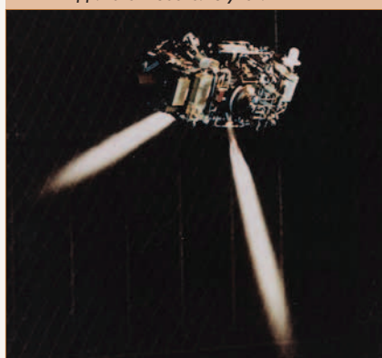
Испытания РДТТ Mk. 142
