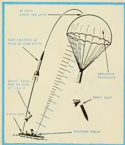
THE WASP IS A SINGLE-STAGE SOLID PROPELLANT ROCKET
