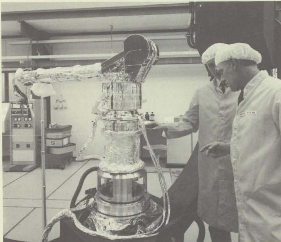
*Préparation aux essais thermiques sous vide de l'adaptateur des mécanismes d'entraînement et de déploiement du réseau solaire du Télescope spatial à l'ESTEC.*
