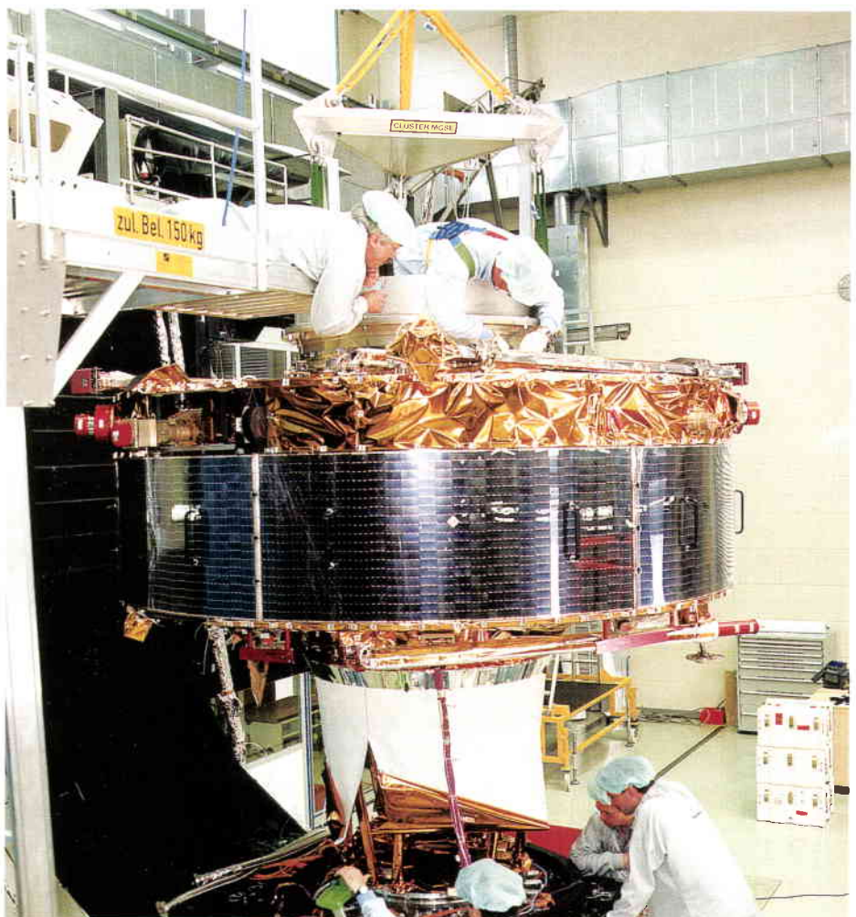
Le satellite Cluster aux essais thermiques chez IABG, Munich (Allemagne)
