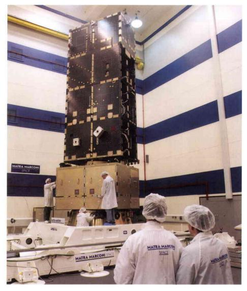
The Polar Platform structural model Modèle structurel de la plate-forme polaire
