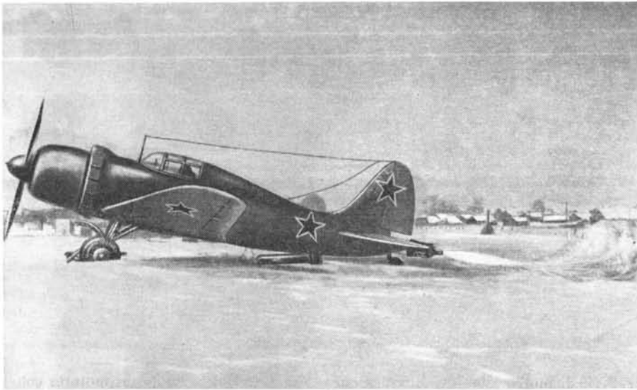
Fig. 22. Essai au sol du moteur « ПД-1X3 » sur l'avion « Cy-7 ». L'avion totalisa 84 lancements avec ce moteur en vol et au sol (1945).
