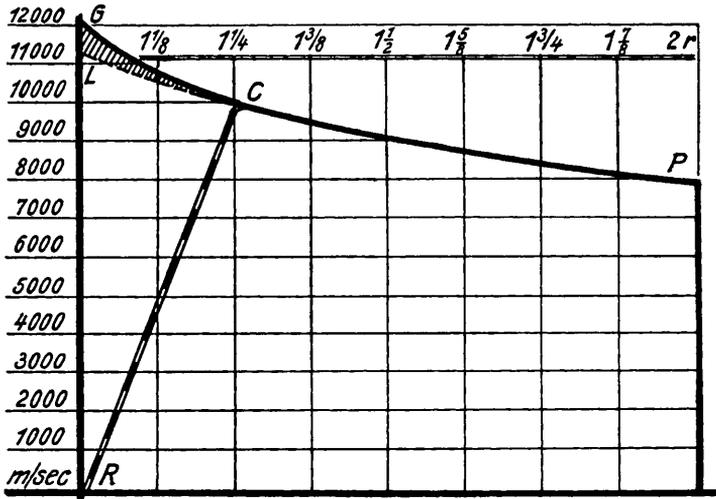
Abb. 20. Schaulinie der Geschwindigkeit beim Aufstieg. GC beim Kanonengeschöß, RC bei der bemannten Rakete, deren Beschleunigung 30 m in der Sekunde nicht übersteigen darf.
