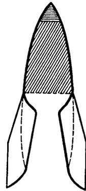
Abb. 23. Einfache Pulverrakete mit verbesserter Spitzenform und Steuerflächen, um den Luftwiderstand zu vermindern und ein Sich-überschlagen zu verhindern.
