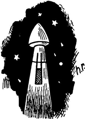
Abb. 30. Letztes Teilstück der in Abb. 29 im Schnitt gezeigten Dreifachrakete, wie es im Weltenraume weiterfliegt, nachdem *AR* und *HR* bereits zurückgelassen worden sind.
