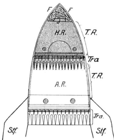
Lbb. 28. Große Oberth'sche Doppelrakete. *HR* Wasserstoffrakete, *AR* Alkoholrakete, *TR* Tankraum, *Tra* Treibapparat, *Stf* Steuerflügel, *F* Fallschirm, darunter *I* die Beobachterkammer.
