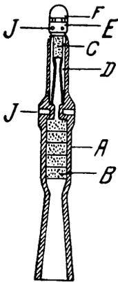
Abb. 24. Schnitt durch eine Goddard'sche Doppelrakete.
