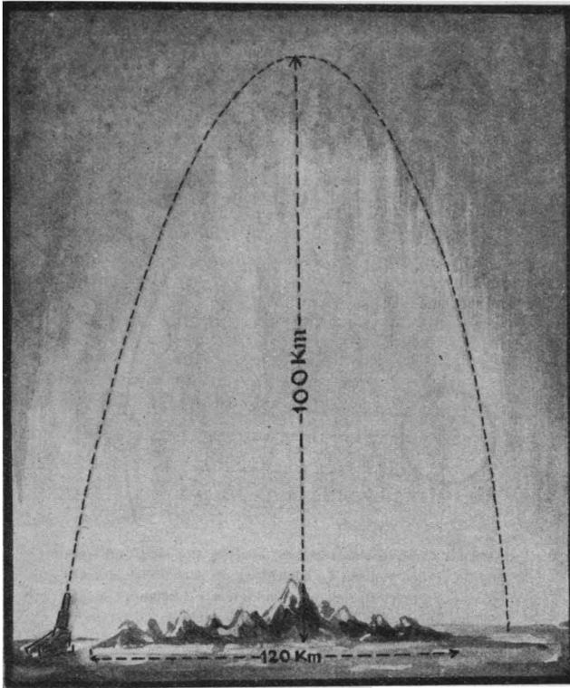
Abb. 11. Mutmaßliche Geschößbahn bei den bisherigen Ferngeschützen, im Vergleich zum Himalaya-Gebirge. Schußweite 120 km, Steighöhe 100 km, Anfangsgeschwindigkeit des Geschößes etwa 1600—1700 m/sec.
