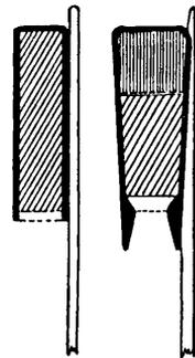
Abb. 21. Einfache u. bessere Feuerwerksrakete im Querschnitt.
