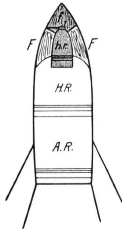
Abb. 29. Schematischer Schnitt durch eine große Oberth'sche Dreifachrakete. *AR* Alkoholrakete, *HR* große Wasserstoffrakete, *hr* obere, kleine Wasserstoffrakete, *f* Fallschirm, *I* Beobachterkammer.
