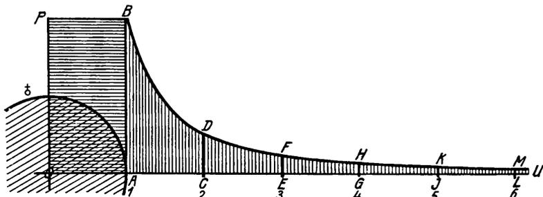
Abb. 1. Schaulinie der Erdschwere. Auf der Wagrechten ist der Abstand vom Erdmittelpunkte in Erdhalbmessern (1, 2... 5, 6) aufgetragen, die Höhe der Loten AB, CD oder EF usw. versinnlicht die Stärke der Erdschwere in der betreffenden Entfernung OA, OC oder OE usw. Die gesamte Kurvenfläche ABU ist gleich groß wie das Rechteck ABPO. Der Erdball ist als Kreis um den Punkt O mit dem Zeichen der Erde  $\delta$  angedeutet.
