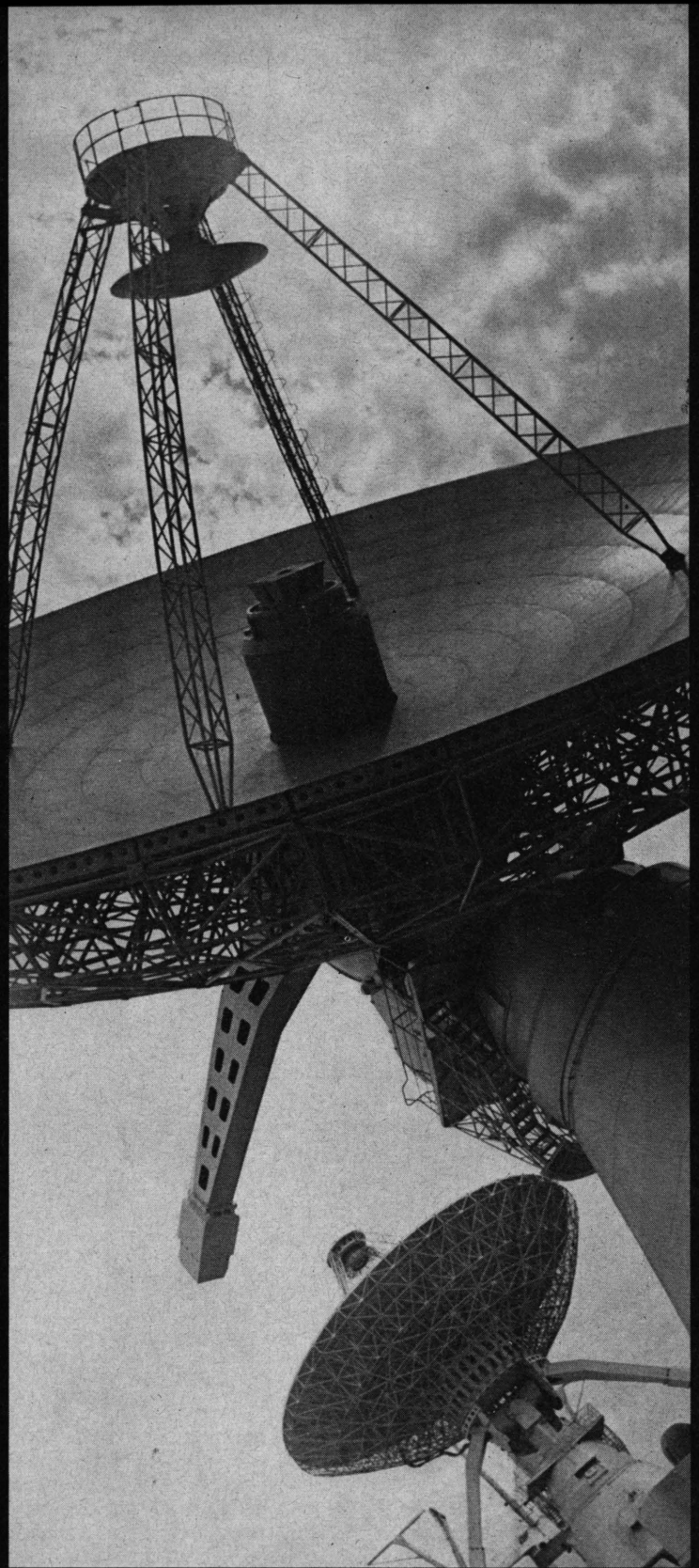
Die beweglichen Paraboloid-Antennen auf der „Kosmonaut Juri Gagarin“ sind die größten, die jemals auf einem Schiff installiert wurden Foto: M. Natschinkin, APN
