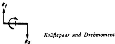
Nicht immer lassen sich Kräfte zusammensetzen. Sind zwei Kräfte gleichlaufend und entgegengesetzt, und greifen sie an einem Körper an, so kann man keine Mittelkraft bilden. Man erkennt aus dem beistehenden Bilde, daß sie die Verbindungslinie, etwa einen Stab, drehen müssen. Die Kräfte, die man ein Kräftepaar nennt, ergeben also ein Drehmoment.
