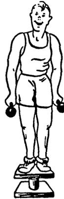
*Der Schwerpunkt des Systems liegt nahe an der Drehachse. Schnelle Drehung bei Anstoß mit derselben Wucht wie vorher*
