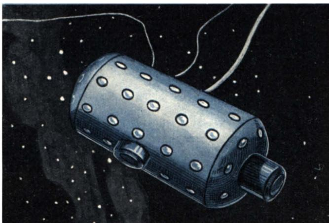
Abb. 91. Beispiel für die Ausführung des Observatoriums. Es hat annähernd die Form eines Kessels mit Rücksicht auf den darin herrschenden Überdruck von 1 Atm. Die Luftschleuse, zwei elektrische Kabel (links), das biegsame Luftrohr (rechts) und die Beleuchtungsluken sind erkennbar.
