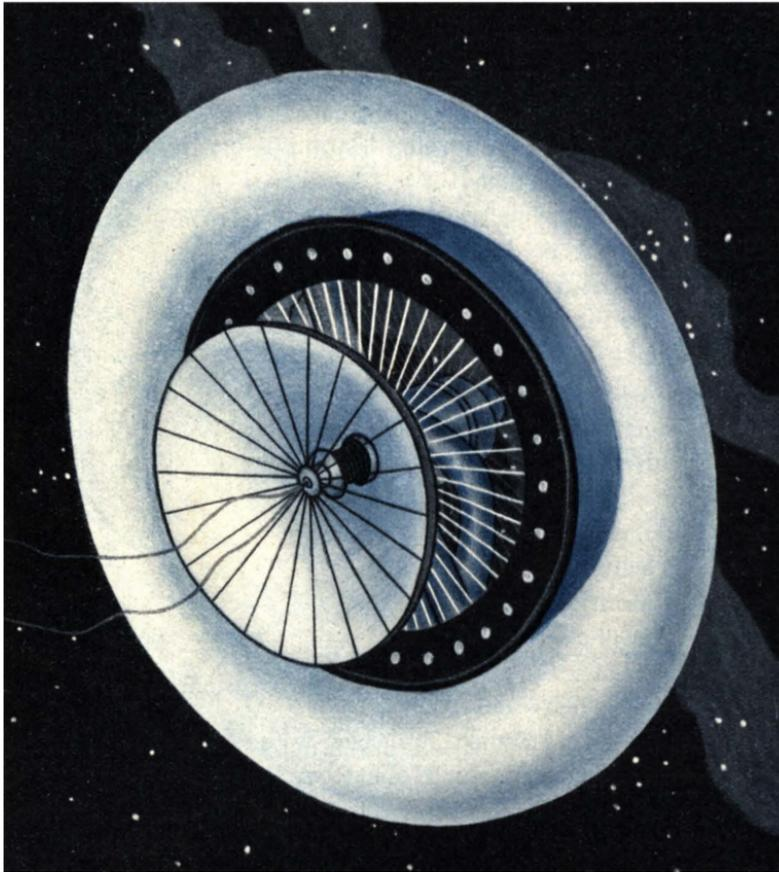
Abb. 89. Gesamtansicht der Sonnenseite des Wohnrades. Der mittlere Sammelspiegel könnte auch weggelassen und durch entsprechende Vergrößerung des äußeren Spiegels ersetzt werden.
