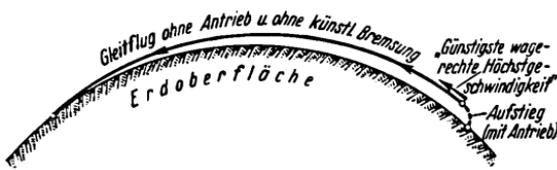
Abb. 53. Vorteilhafteste Art der Ausführung eines „Eilfluges mit kosmischer Geschwindigkeit“: Die wagrechte Höchstgeschwindigkeit wird — entsprechend der Entfernung — so groß gewählt („günstigste wagrechte Höchstgeschwindigkeit“), daß die ganze Fernfahrt im Gleitflug ohne Antrieb und ohne künstliche Bremsung zurückgelegt werden kann (Schema siehe Abb. 50).
