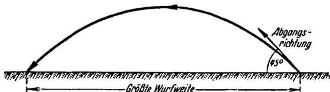
Abb. 47. Mit einer gegebenen Abgangsgeschwindigkeit wird dann die größte Wurfweite erzielt, wenn der Abgangswinkel  $45^\circ$  beträgt.
