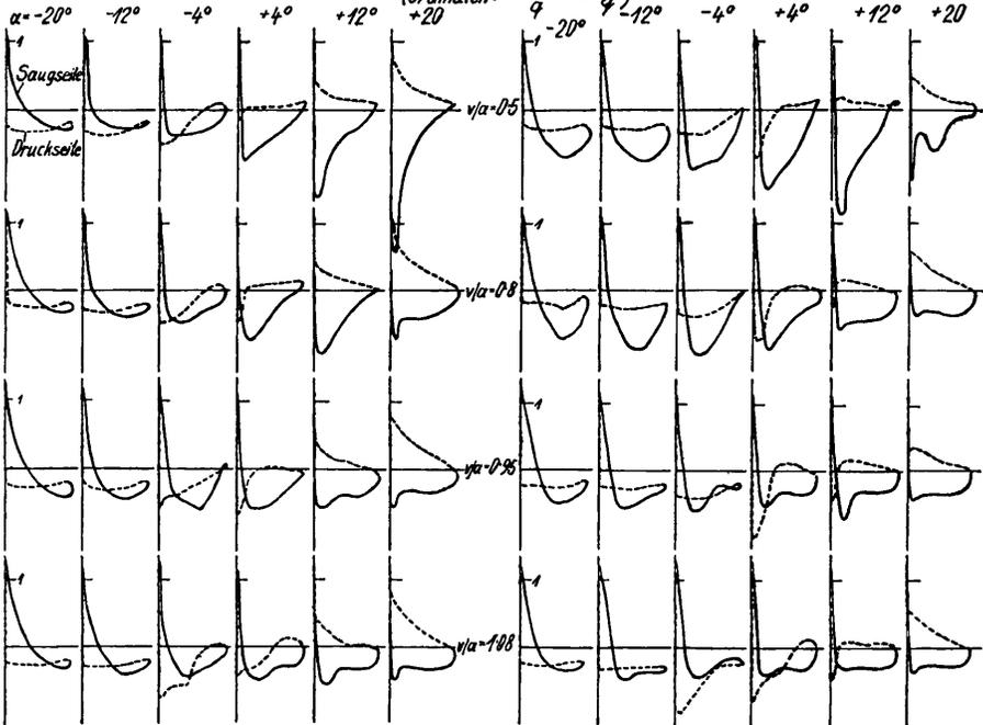
Abb. 19. Auszug aus den Briggsschen Versuchsergebnissen über Luftkräfte an Flügelprofilen bei hoher Geschwindigkeit.
