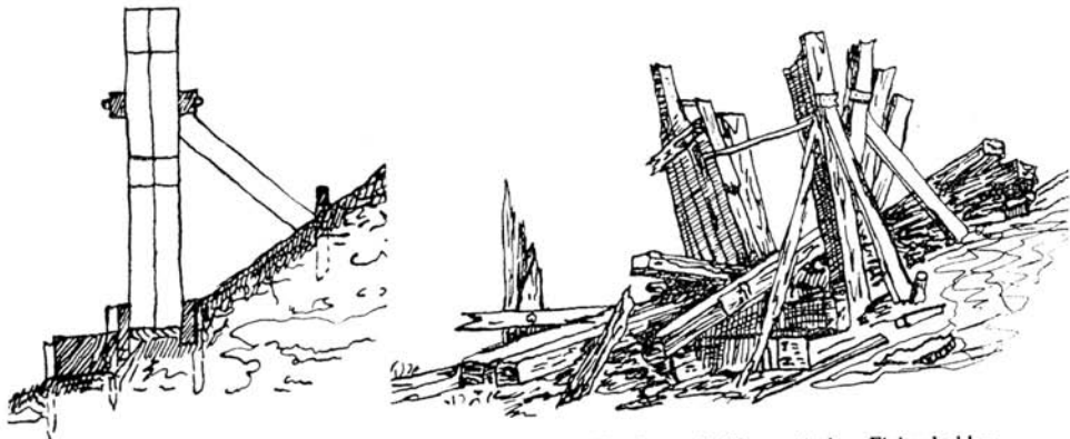
Wirkung einer Congreveschen Granatrakete auf eine Wand von 2 \times 15 cm starken Eichenbohlen. [Aus einem nur für den militärischen Gebrauch bestimmten Druck von 1824.]
