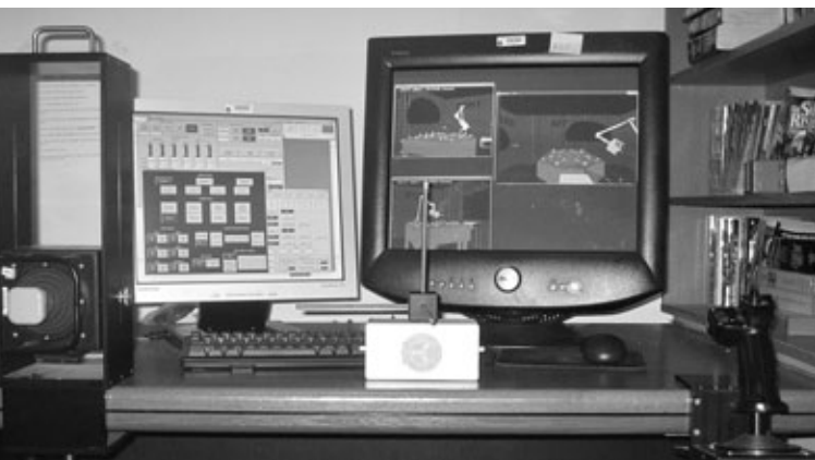
Компьютерный тренажер DST (Dynamic Skill Training), установленный в офисе НАСА в ЦПК. На мониторе справа просматривается «рука» виртуального манипулятора и площадка с полезным грузом, «заснятая» несколькими камерами
