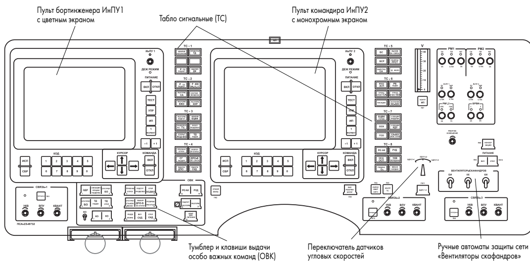
Схема пульта космонавтов корабля «Союз ТМА». Рисунок из учебного пособия
