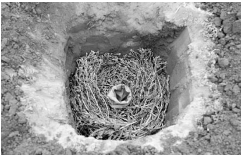
...в качестве источника влаги используется местная флора. Пары воды конденсируются на пленке, капли стекают в заготовленную емкость
