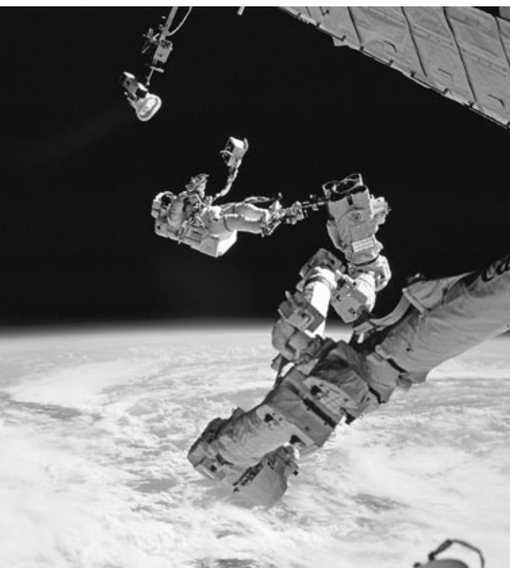
С помощью манипулятора SSRMS астронавтов доставляют в удаленные места на поверхности МКС. Октябрь 2002 года, астронавт Дэвид Вульф. Фото НАСА
