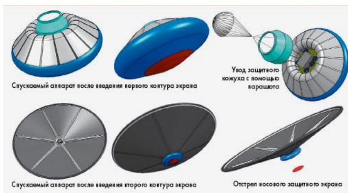
Рис. 3.34. Схема раскрытия тормозного устройства
