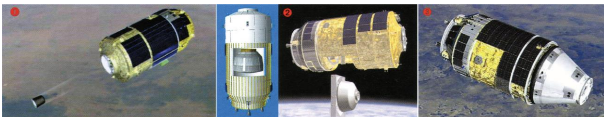
Рис. 1.76. Варианты ТКГ НТВ-R с грузовозвращаемой капсулой
