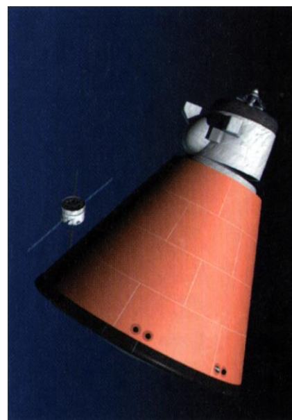
Рис. 1.48. Разделение отсеков КК «ARV» перед входом в атмосферу
