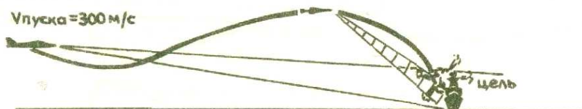
Схема боевого применения ПКР на базе Х-58.
