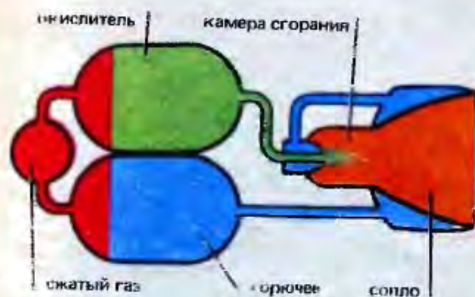
Схема небольшого жидкостного ракетного двигателя
