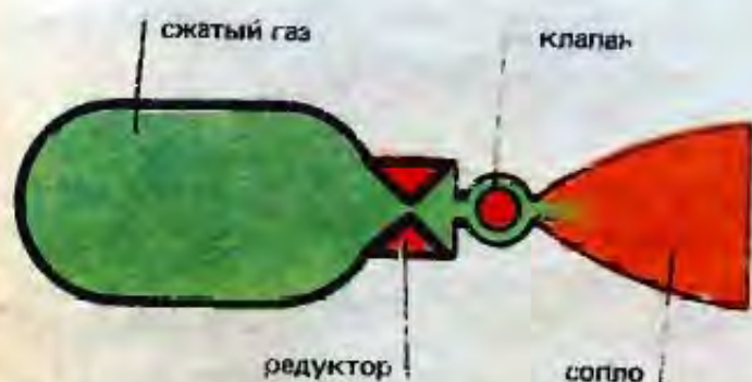
Схема газового ракетного микродвигателя
