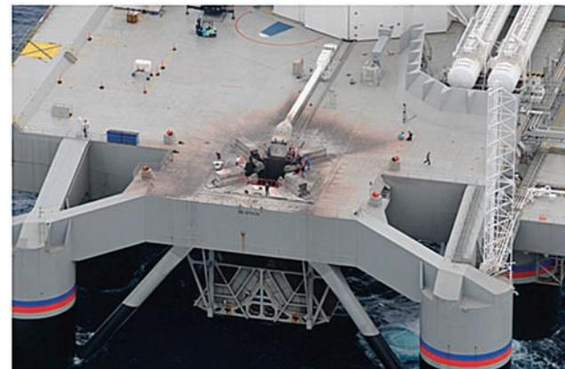
**Рис. 34. Состояние стартовой палубы платформы после пуска ракеты**
