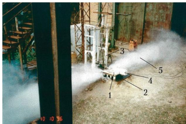
**Рис. 14. Работающая «горячая» модель РКН масштаба M1:72 с платформой и емкостью с водой на газодинамическом стенде РКК «Энергия»:** 1 – СП; 2 – бассейн с водой; 3 – РКН; 4 – ангар; 5 – парогазовая смесь на выходе из газоотражателя
