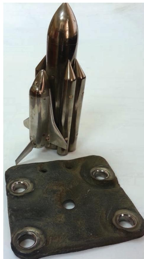
*Рис. 2. Последствия воздействия на титановую заглушку, расположенную на внешней поверхности блока «Я» стартового комплекса «Энергия–Буран», струй двигательной установки ракеты-носителя «Энергия», растекающихся по поверхности*
