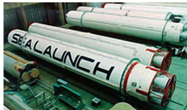
Рис. 4. Ракета «Зенит» (первые две ступени) в трюме сборочно-командного судна
