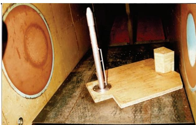
Рис. 5. Модель для исследования аэродинамических характеристик РКН в присутствии СП при ветровом воздействии в аэродинамической трубе У-21 ЦНИИмаш
