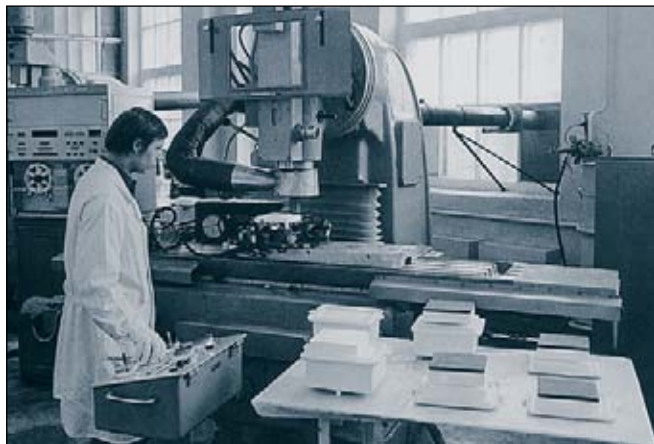
Изготовление плиток теплозащитного покрытия для «Бурана» на станке с числовым программным управлением от ЭВМ. Тушинский машиностроительный завод (ТМЗ).
