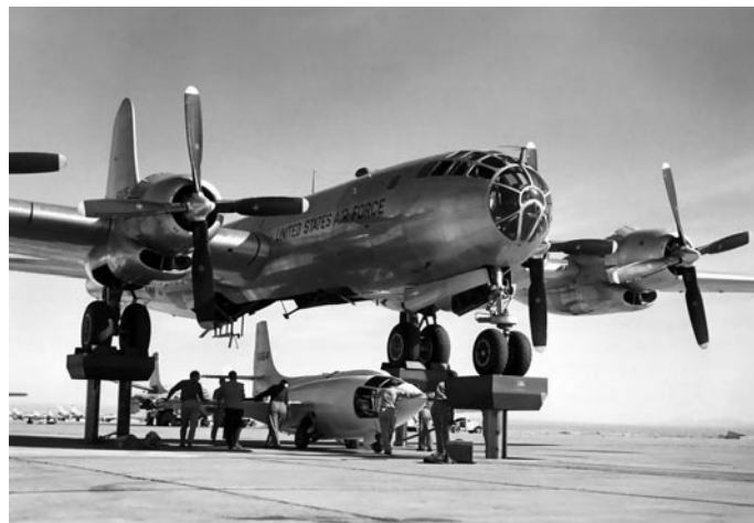
Процедура подвески X-2 №3 под самолет-носитель B-50
