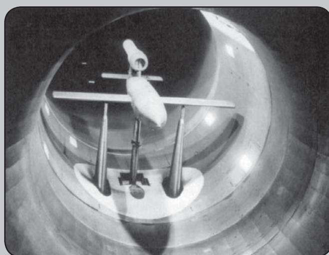
Продувка ракеты Fi-103 в аэродинамической трубе. США, 1944 год
