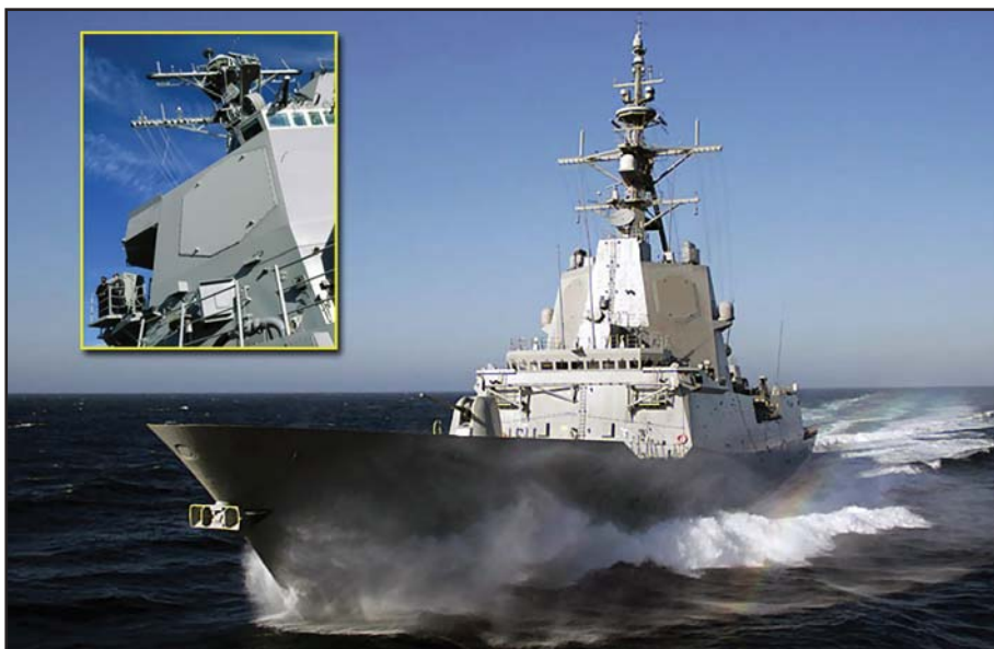
«Глазами» системы вооружения является радар AN/SPY-1, охватывающий всю верхнюю полусферу, придающий характерный облик кораблям с системой Aegis
