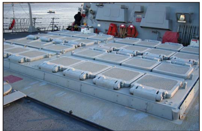
Универсальная палубная ПУ сотового типа Mk.41
