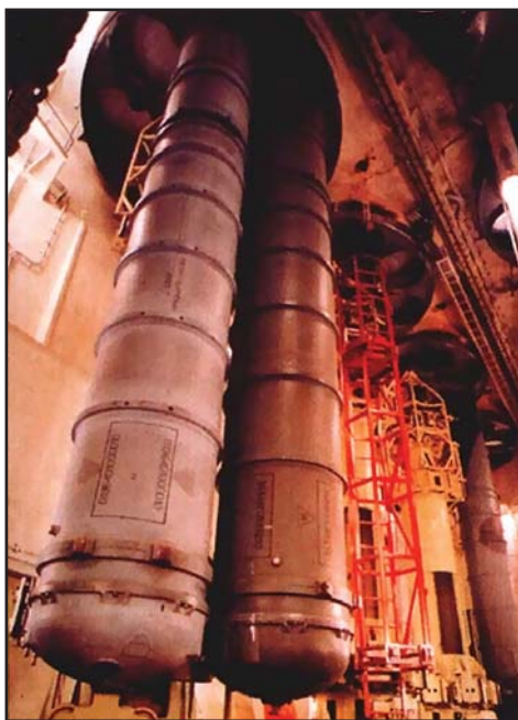
Подпалубная пусковая установка Б-203А барабанного типа. В каждом барабане устанавливается по 8 ЗУР 48Н6Е2 в ТПК
