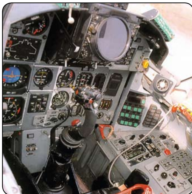
Новая кабина летчика МиГ-31М среди прочего получила индикатор тактической обстановки, на который выводится информация от РЛС параллельно со штурманом
