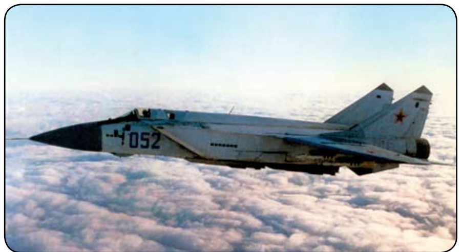
Второй опытный самолет МиГ-31М: на подвеске шесть макетных ракет большой дальности Р-37 под фюзеляжем и четыре Р-73 малой дальности под крылом. Фото: АНПК «МиГ»
