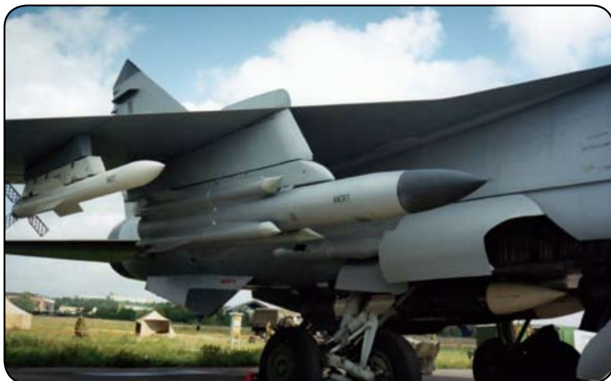
Ударное вооружение МиГ-31БМ — под левым крылом противорадиолокационная ракета X-58, а под правым — противокорабельная X-31А. Фото: С.Г. Мороз
