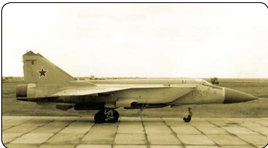
Фюзеляж, крыло и оперение третьего опытного МиГ-31М уже были новыми, но вооружение и оборудование пока существовало только в макетных вариантах
