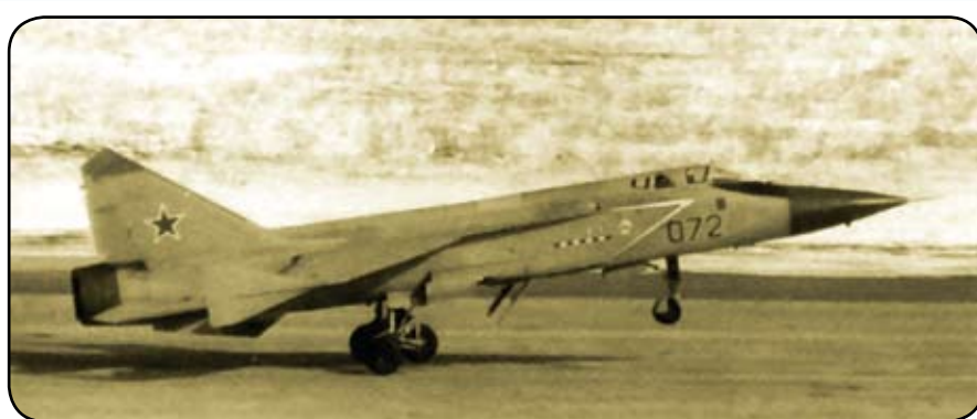
Второй опытный МиГ-31Д выполняет посадку. «Ласты» на концах крыла нужны для обеспечения устойчивости и управляемости самолета на специфических режимах перехвата спутника
