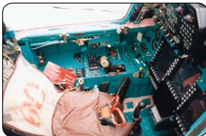
В кабине штурмана МиГ-31М появились три цветных многофункциональных индикатора, которые обеспечивают работу со всеми видами боевых систем БРЭО и вооружения
