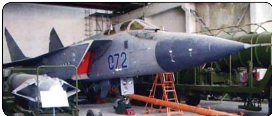
Второй опытный образец противоспутникового самолета МиГ-31Д (борт 072) и ракета-перехватчик на закрытом показе военной техники
