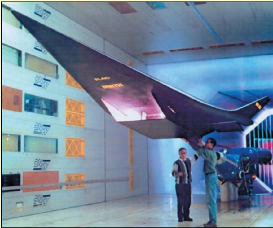
Большая модель ELAC 1 (длиной более 6 м) в рабочей части германско-голландской аэродинамической трубы DNW малых скоростей
