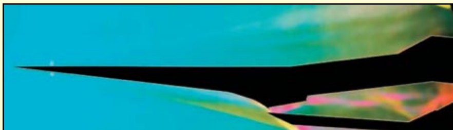
Теневая фотография обтекания модели ELAC 1 с воздухозаборником в гиперзвуковой ударной трубе ( M = 7,3 ) в Ахене. Красивые радужные сполохи в правой нижней части снимка представляют собой хаотические течения внутри воздухозаборника
