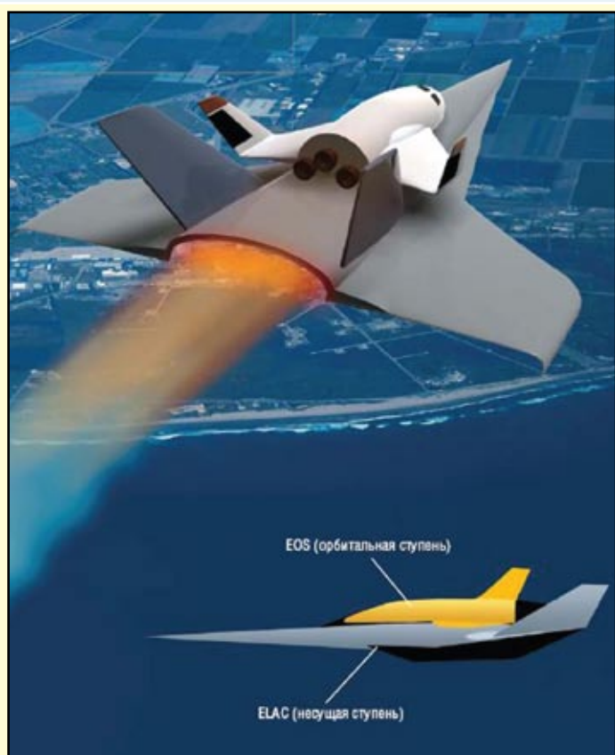
Схема модели двухступенчатой аэрокосмической системы ELAC–EOS. Эти аппараты будут взлетать и садиться горизонтально, подобно обычным самолетам. Предполагается, что длина полномасштабной конфигурации составит 75 м, а размах крыла — 38 м
