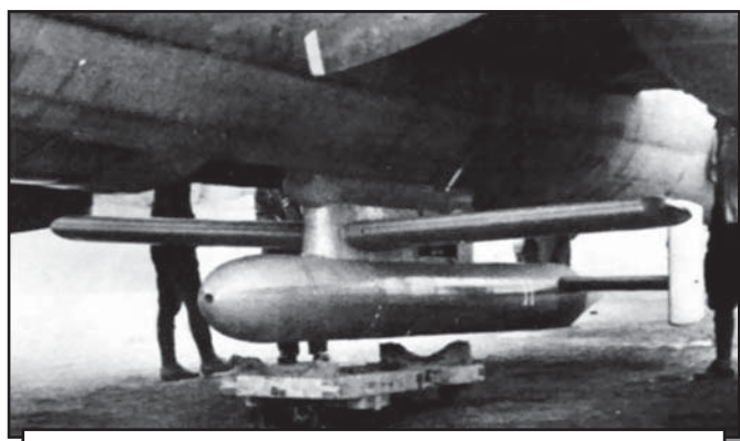
Управляемая ракета (планирующая ракетная бомба) с радиокомандным управлением Ки 147 «И-Го» Тип 1-а на подвеске под самолетом-носителем Ки 67-1 Go-IA «Хириу», 1945 г.
