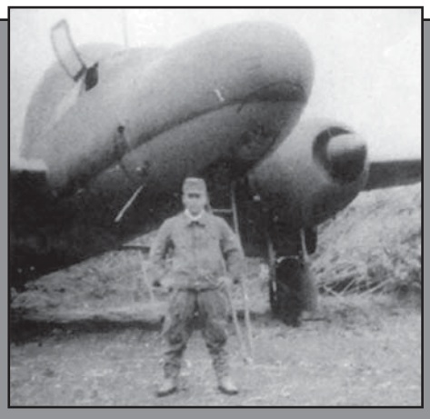
Самолет для атак камикадзе Ki 67-I-KAI «То-Го» переоборудовался из строевых бомбардировщиков «Хиру» путем установки термитной бомбы в носовой части
