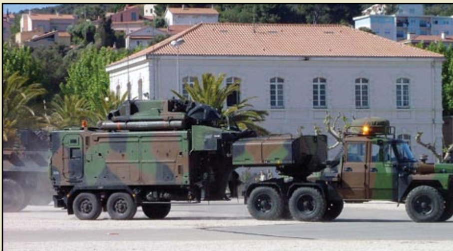
Буксируемый вариант ЗРК «Roland II» под обозначением «Carol»
