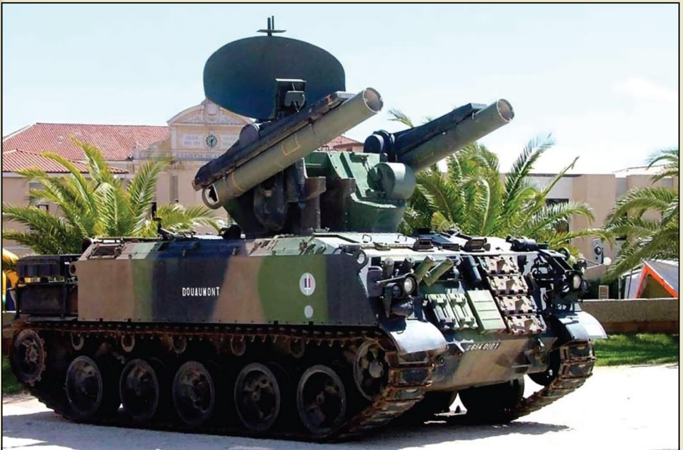
«Roland» — немецко-французский ЗРК. Предназначена для непосредственного прикрытия наземных войск, для борьбы с маневрирующими аэродинамическими целями на малых и средних высотах, в условиях интенсивного радиопротиводействия. Способна уничтожать цели, летящие со скоростью до M=1.2 на высотах от 15 м до 5.5 км и на дальностях от 500 м до 6.3 км. На фото: ЗРК «Roland II» на шасси AMX-30
