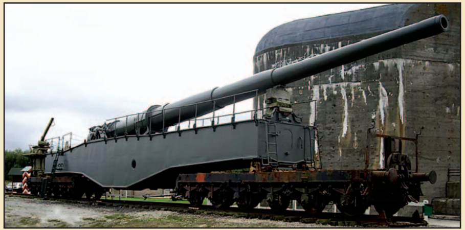
280-мм пушка K5 (E) на железнодорожной платформе. В войсках она сразу получила неофициальное название Schlanke Berta — «стройная Берта» как признание ее удачного наружного дизайна
