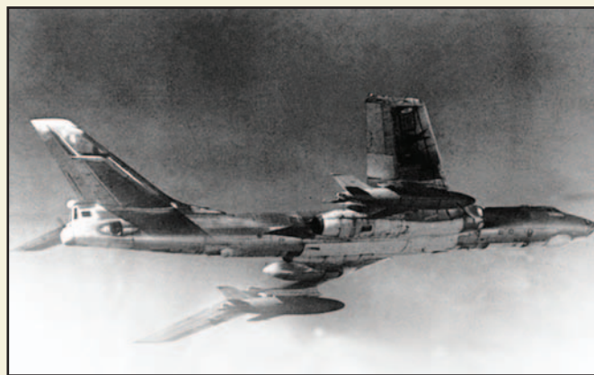
Самолет Ту-16К-11-16 с противорадиолокационными ракетами КСР-11 и аппаратурой радиоэлектронных помех. Фото: АНТК им. Туполева
