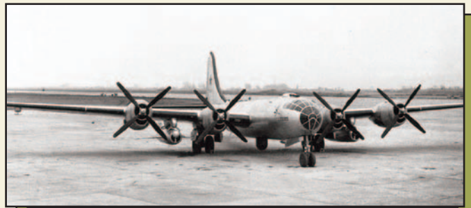
Ракетносец Ту-4К с подвешенными самолетами-снарядами «Комета» на аэродроме. Антенна РЛС наведения «Комета К-1» в выпущенном положении. Фото: АНПК «МиГ»
