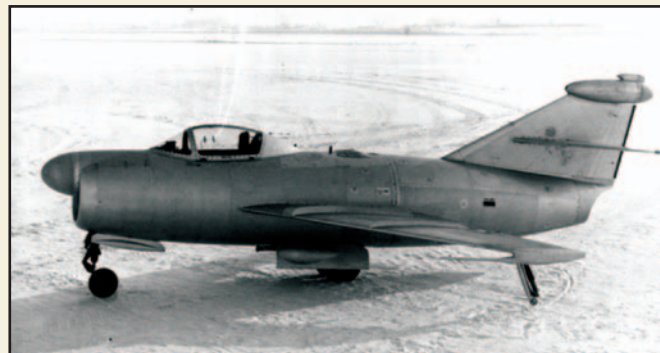
Самолет «К» — аналог крылатой ракеты КС-1 «Комета» с кабиной летчика на месте боевой части служил для отработки системы наведения Фото: Архив АНПК «МиГ»
