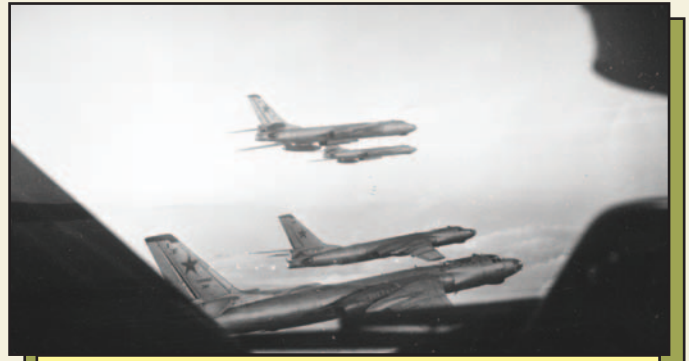
Ракетоносцы Ту-16К-16 выполняют бомбометание в плотном строю. На самолетах этого типа практиковалась одновременная подвеска бомб и самолетов-снарядов КСР-2. Фото: архив С.А. Попсуевича
