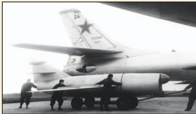
Подвеска самолета-снаряда КС-1 «Комета» на ракетносец Ту-16КС в строевом полку ВВС Северного Флота. Фото: АНПК «МиГ»
