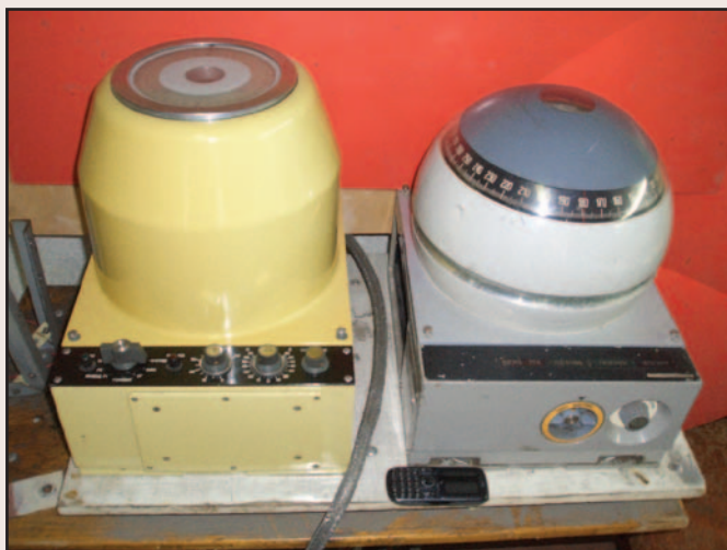
Советские шедевры: гиросуказатели на жидкостно-торсионной подвеске ГКУ-2 (военный вариант), ГКУ «Вега» (гражданский вариант)
