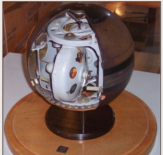
Гиросфера гирокомпаса типа Аншютц-Кемпфе в разрезе
