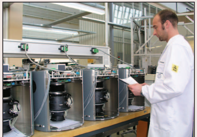
Тестирование гирокомпаса Anschutz Standard-22 на заводе в Киле, Германия
