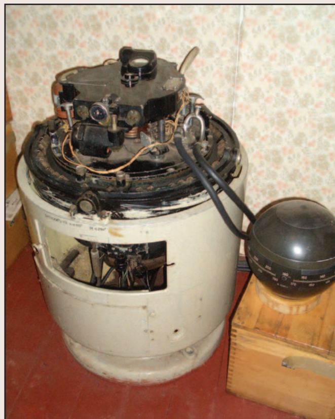
Гироскопический компас «Аншут стандарт 1» водяного охлаждения, он же «Курс-4» (Russian Anschutz)
