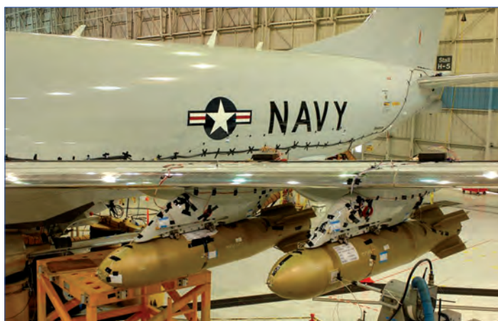
Отработка бомбардировочного и минного вооружения серийного самолета Р-8А «Посейдон» на заводе «Боинг» в г. Рентон
