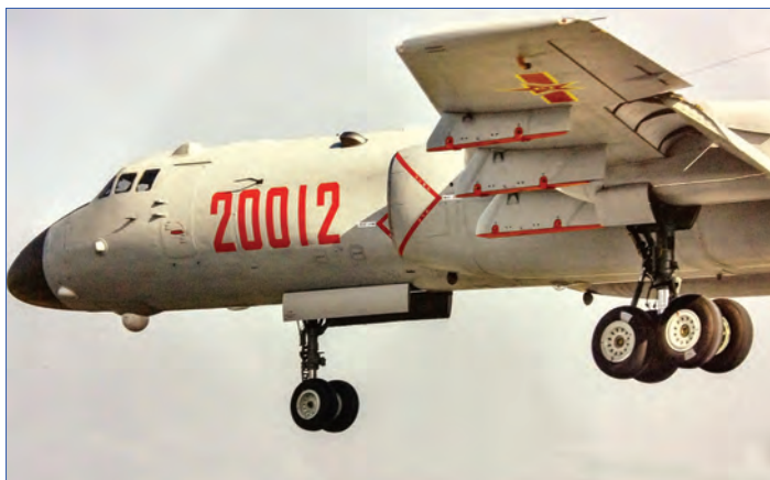
Вид крупным планом на новую носовую часть, увеличенные gondолы двухконтурных двигателей WS-18 и пилоны для подвески вооружения самолета Сиань Н-6К Самолет Н-6К СЯС КНР с шестью подкрыльными узлами
