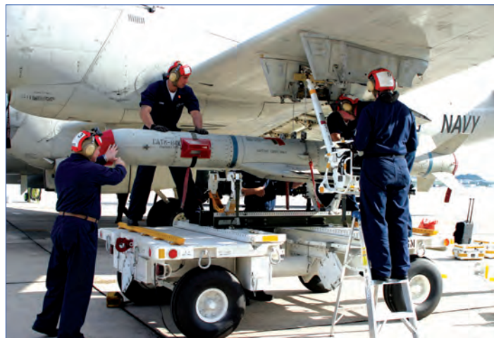
Подвеска на самолет Р-3С «Орион» ВМС США учебной ракеты CATM-84К, которая заменяет на учениях боевые AGM-84H/K SLAM-ER
