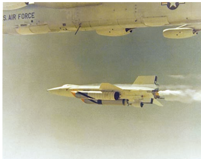
Старт экспериментального гиперзвукового самолета X-15 с борта носителя NB-52. Ракетоплан был оснащен жидкостным ракетным двигателем, который мог работать лишь несколько десятков секунд. Фотомо: http://www.businessinsider.com/the-b-52-has-a-remarkable..
