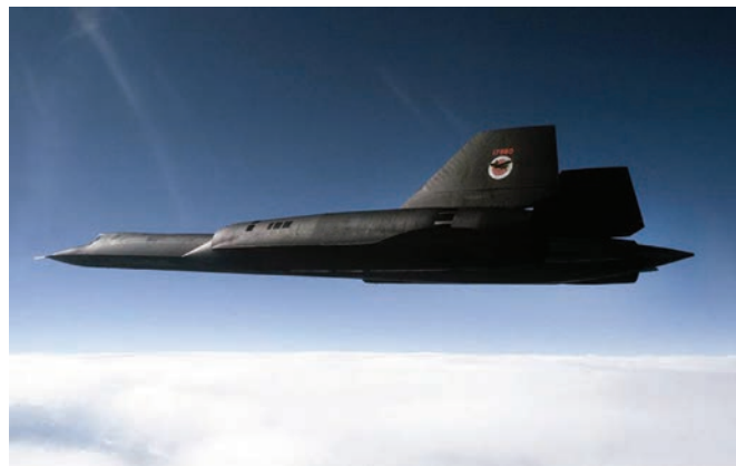
Стратегический разведчик Локхид SR-71A «Блекберд» — пока единственный американский серийный самолет, который мог летать втрое быстрее звука. Его силовую установку составляли два ТРД, помещенных в огромные гондолы-эжекторы.
