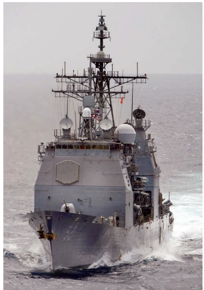
Ракетный крейсер USS Montrey. Водоизмещение полное 9600 т. Длина 173 м, ширина 16,8 м, осадка 10,2 м. Скорость хода более 30 узлов. Дальность плавания 6000 морских миль на 20 узлах. Экипаж 400 человек, в том числе 33 офицера. Вооружение: две пусковые установки Mk 41 вертикального пуска для управляемых ракет. Всего рассчитаны на 122 ракеты, состоящие из: крылатых ракет «Томагавк»; противолодочных ASROC; зенитных управляемых ракет «Стандарт-2» и «Стандарт-3»
