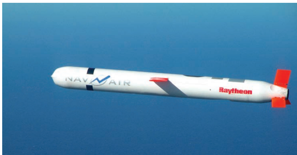
Крылатая ракета морского базирования «Томагавк». Имеет дальность 1600 км, круговое вероятное отклонение от цели — 10–15 м. Масса БЧ — 340 кг. Максимальная скорость — 880 км/ч
