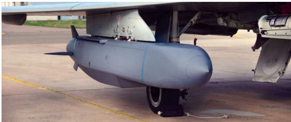
Новейшая французская ракета Scalp EG, основные размеры корпуса 5100 x 630 x 480 мм, дальность 400 км, скорость 1050 км/ч, стартовый вес 1230 кг, размах стреловидного крыла в маршевом положении 2,53 м, БЧ до 700 кг
