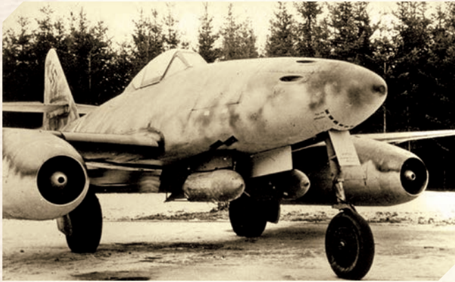
Реактивный истребитель-бомбардировщик «Мессершмитт» Me 262A-2a из состава I/KG 51 с двумя 250-кг бомбами
