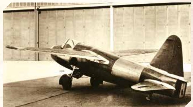
Второй прототип He 178V-2 с прямым трапецевидным крылом
