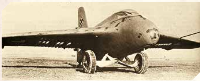
Me 163A, оснащенный реактивными снарядами «воздух—воздух» R4M, во время испытаний по возможности их применения
