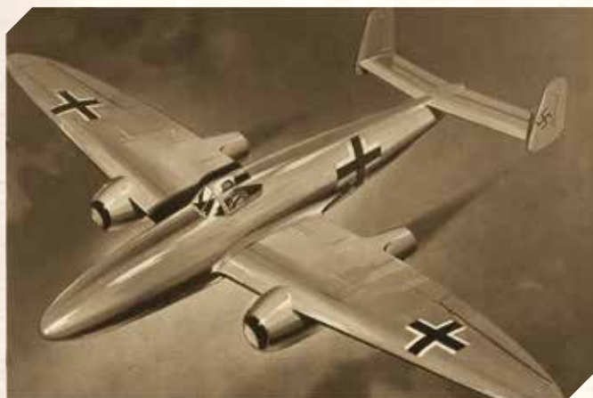
Проект истребителя Heinkel He 280 с расположением кабины экипажа за передней кромкой крыла
