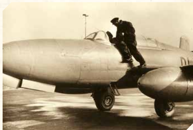
Прототип He 280V-1 с обтекаемыми гондолами вместо ТРД HeS 8A перед планирующим полетом
