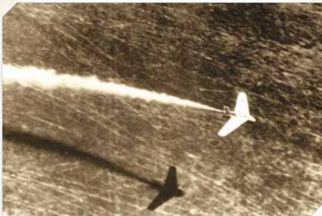
Основным признаком, по которому экипажи самолетов союзников обнаруживали старт ракетопланов, был светлый шлейф выхлопа жидкостно-ракетных двигателей
