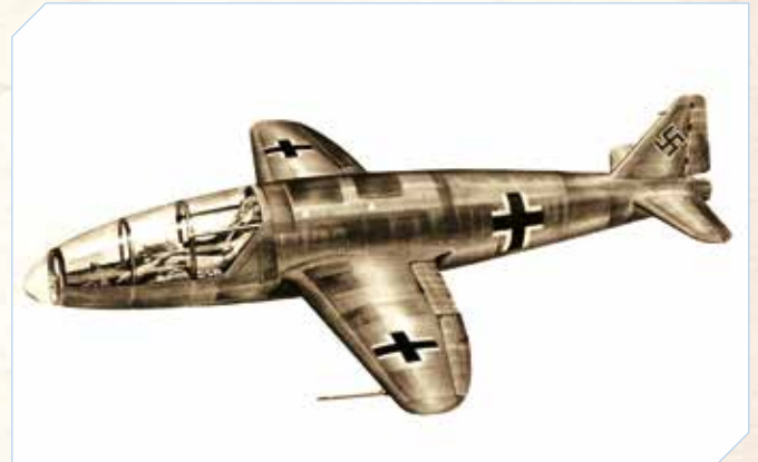
Рисунок второго прототипа He 176V-2, который не был построен, поскольку Эрнст Хейнкель переключился на более перспективные газотурбинные двигатели
