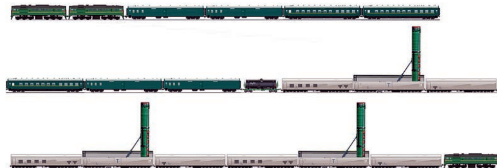
Схема состава БЖРК: три тепловоза ДМ62, командный пункт в составе семи вагонов, вагон-цистерна с запасами горюче-смазочных материалов и три пусковых модуля (каждый в составе трех вагонов) с ракетами
