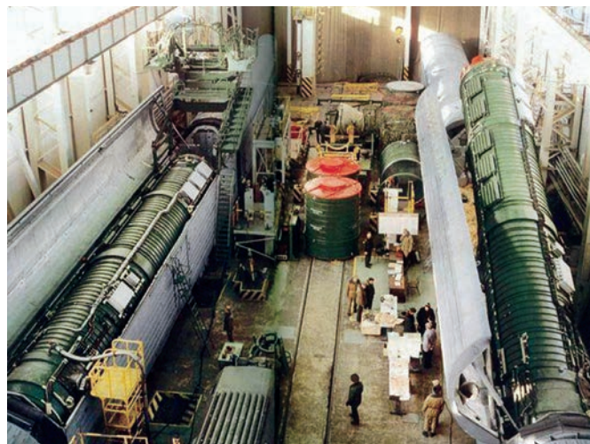
Ракеты для БЖРК собирались на Павлоградском механическом заводе. Готовая ракета прямо в цехе грузилась в вагон и отправлялась на площадку формирования
