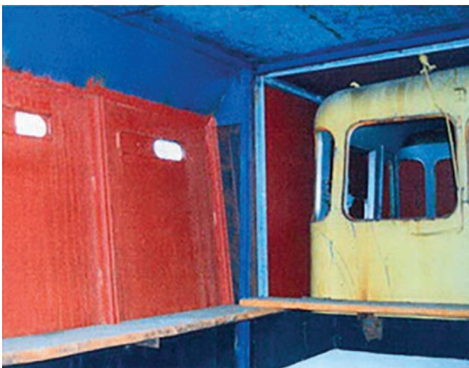
Внутри броневое корпуса была сохранена кабина оригинальной дрезины, из которой и осуществлялось управление. В просторном десантном отделении могли разместиться 15 полностью экипированных солдат
