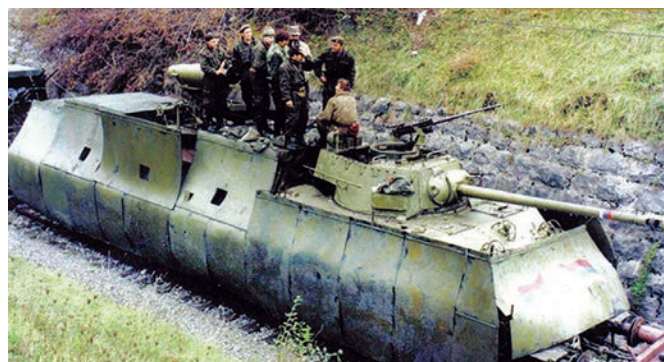
После модернизации 1993 г. бронепоезд «Краина экспресс» получил американское самоходное орудие М18 (калибр 76 мм)
