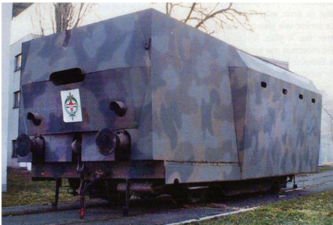
Хорватская бронедрезина «Domoljub 101», вид три четверти спереди. В передней части бронедрезины располагалось отделение управления, в задней — десантное
