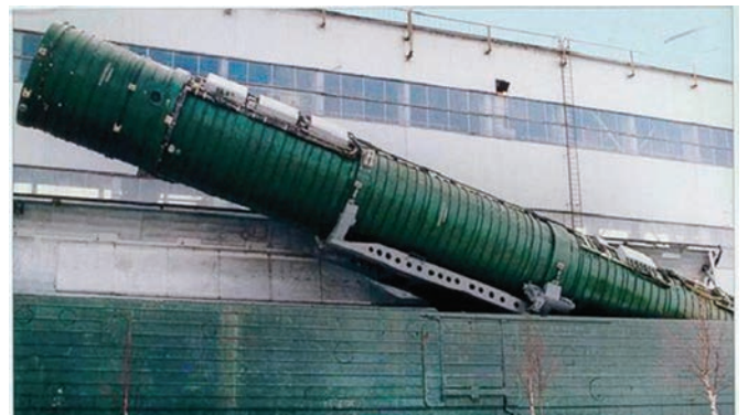
Крыша вагона откинута, контейнер с ракетой частично поднят
