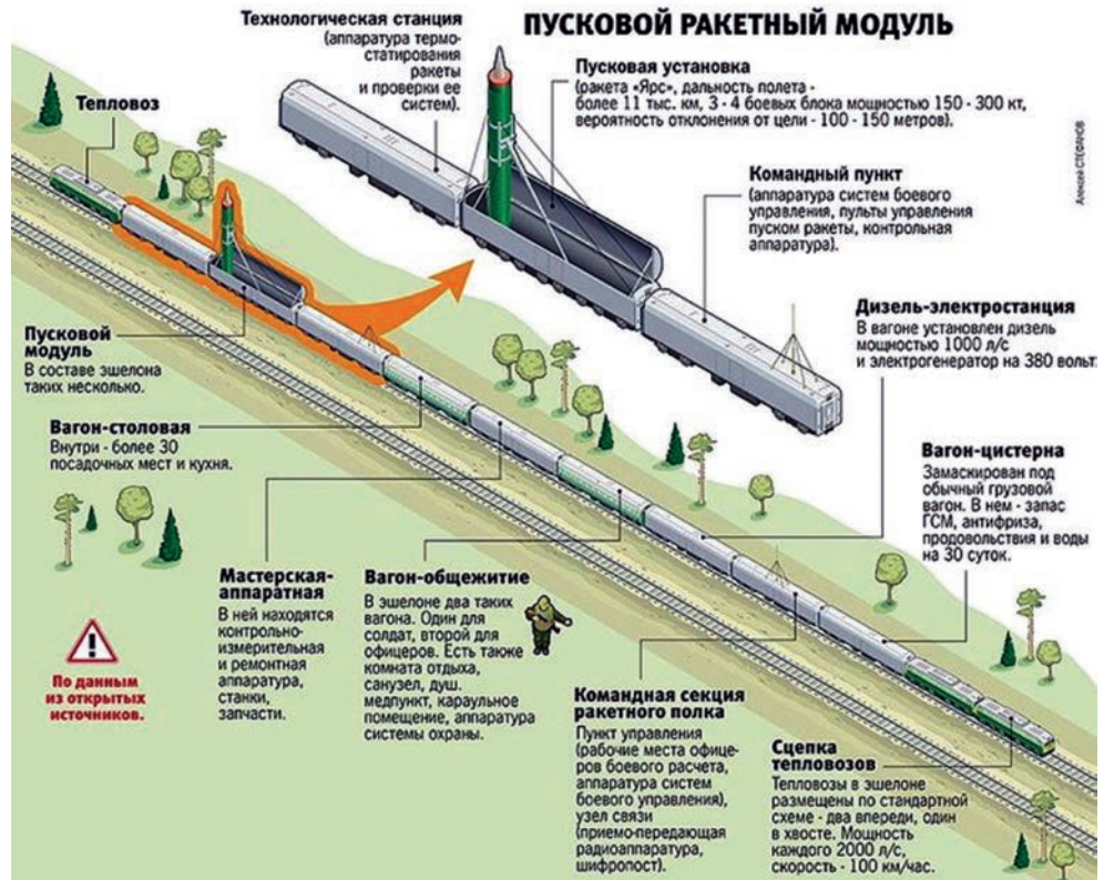
Схема БЖРК «Баргузин». В декабре 2017 г. в Министерстве обороны РФ заявили о прекращении разработки комплекса в связи с экономической ситуацией в стране
