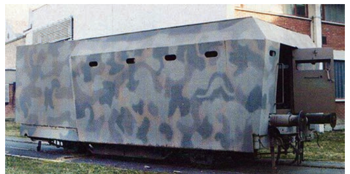
В бортах бронедрезины были сделаны закрывающиеся бойницы, а в корме — дверь для десантирования
