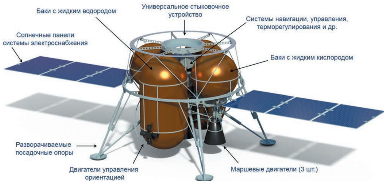
Рис. 5. Компоновочная схема многоразового лунного лендера
